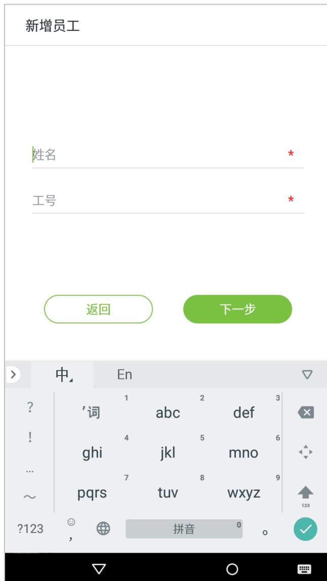
**备注：**本设备支持中文、英文、数字及符号的输入。点击【中】切换为中文键盘；点击【En】切换为英文键盘；点击【?123】切换为数字及符号键盘；点击【返回】键返回至字母键盘。点击输入框，出现软键盘；点击下箭头 图标，隐藏软键盘。
