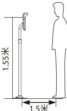
推荐人员与设备之间的距离为 1.5 米以内（适用身高范围 1.55 米 -1.85 米），可根据设备获取人脸图像效果进行调整，当人脸图像较亮时可适当向后移动；当人脸图像较暗时可适当向前移动。
