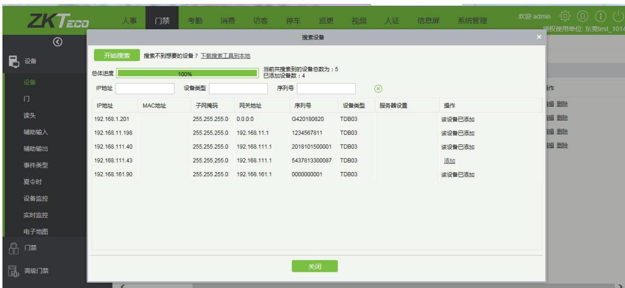
(4) 点击设备后的【添加】：输入自定义的设备名称、图标类型等信息，点击【确定】，完成新增设备。
