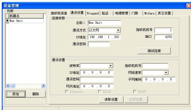
2) 在IP地址栏, 输入设备的IP地址 192.168.1.201 ( 出厂地址 ), 单击“测试连接”按钮。当连接设备成功时, 会弹出“与设备连接成功”消息框, 此时单击“确认”按钮关闭消息框。
