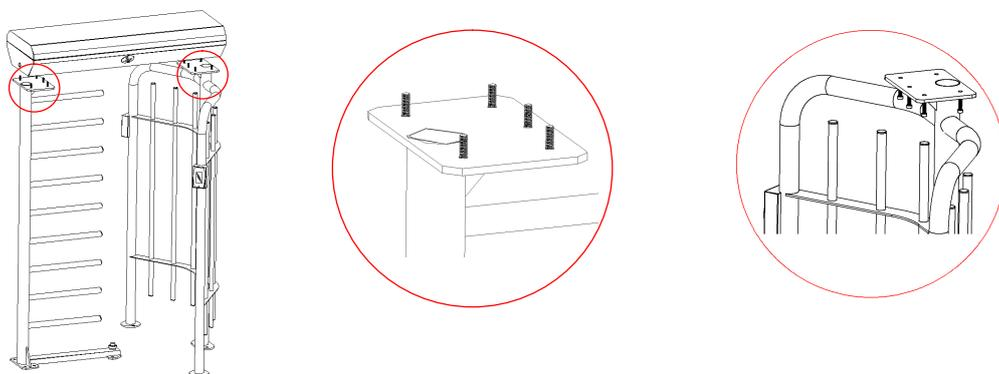
7. 将机箱稍微向上抬起，把整个转动部分的底部套在支架的转动轴承上，顶部用螺丝和锁块连接在机芯的转动杆上并锁紧固定；随后将轴头罩固定锁紧。调整闸机方向及位置后拧紧步骤 6 中的螺丝。
