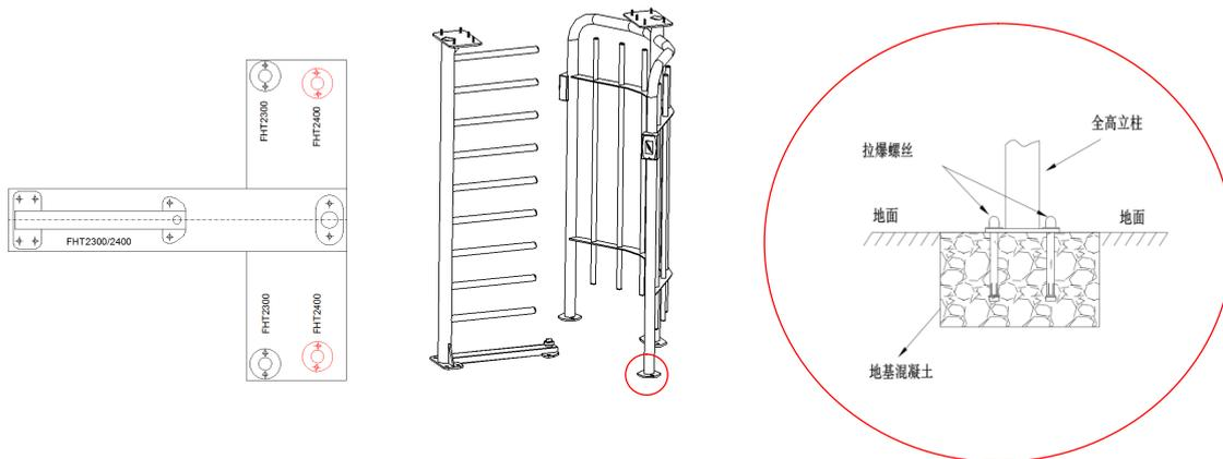
6. 确定机箱方向，将机箱放到两个立柱上，用 M10 的螺丝将机箱和支撑立柱连接在一起，先不要锁紧；
